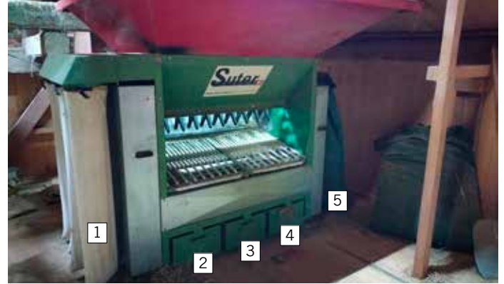
Le fourrage de base est parfaitement préparé à l'aide de l'une des deux machines à foin. Légende: [1] poussière, [2] terre, [3] graines, [4] terre, [5] fleurs de foin
